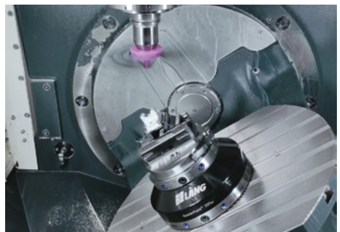
Las aspas del Clean Tec se despliegan y cierran automáticamente con el giro del cabezal.
