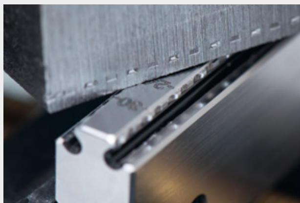
Boca dentada de mordaza Makro·Grip® 5 ejes + huella dentada en pieza
