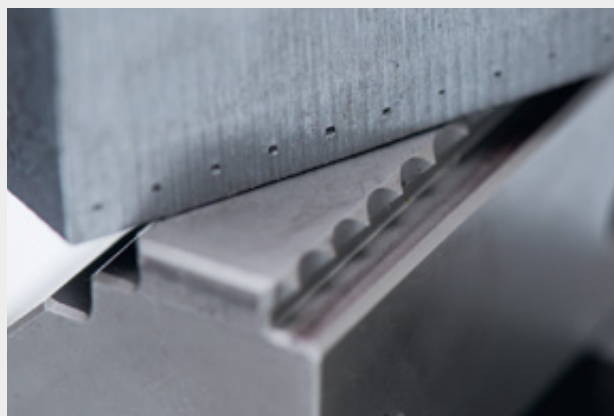
Bocas dentadas de mordaza convencional + indentación de pieza
