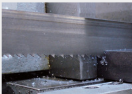
1 – Ahorro de material al utilizar mínima longitud de amarre
